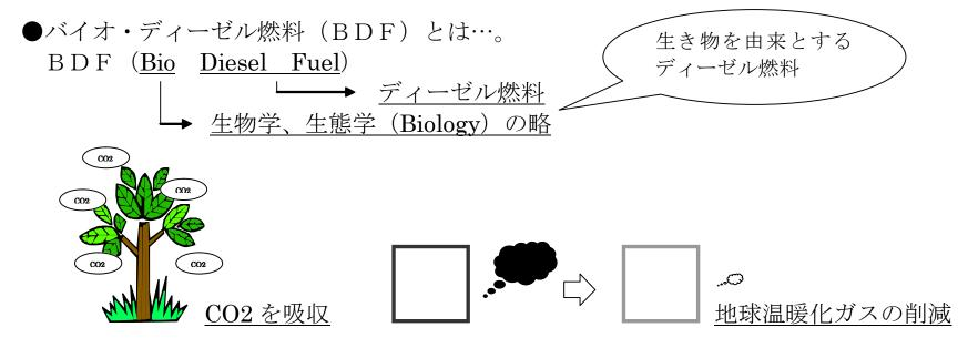
バイオ・ディーゼル燃料は、原料となる植物が生育時に二酸化炭素を大気中より吸収するために京都議定書では二酸化炭素排出量がゼロに見なされ、地球温暖化対策に役立つとされています。また通常の軽油に比べ、排ガス中の黒煙( $NOx \cdot PM$ )が非常に少なく地球温暖化ガスの削減に大変有効と考えられています。
